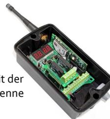
**Abb. 39** Ansicht des Funkempfängers FLEX868 mit der am Gehäuse angebrachten optionalen Antenne ANT868-OB.
