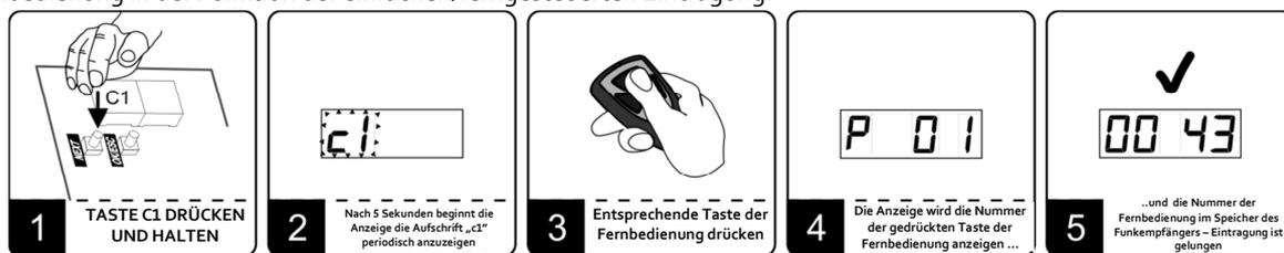
Abb. 4 Beispiel der Eintragung der Taste Nummer 1 in den Kanal C1 des Funkempfängers mit den Tasten C1.
