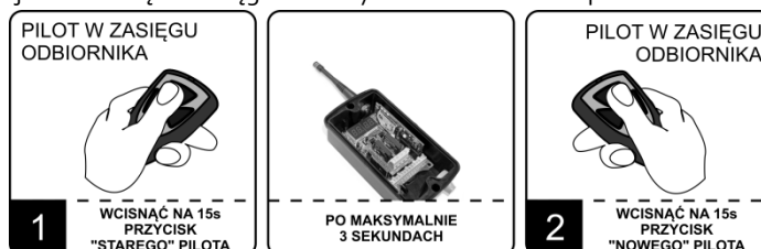
Rys. 5 Zdalne dopisanie pilota znajdującego się w zasięgu radiowym odbiornika.
