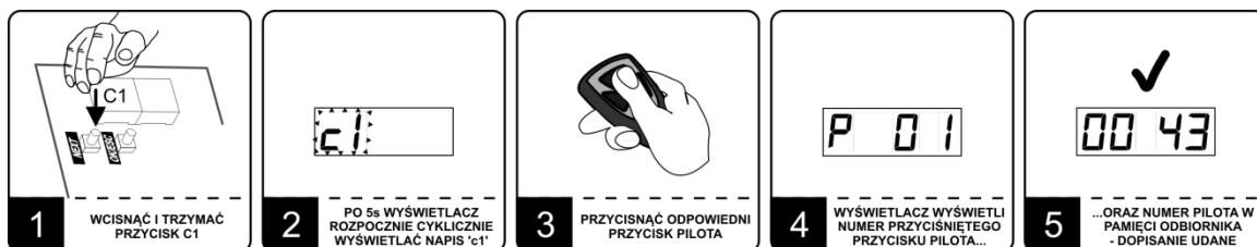
Rys. 4 Przykład dopisania przycisku numer 1 do kanału C1 odbiornika za pomocą przycisków C1.
