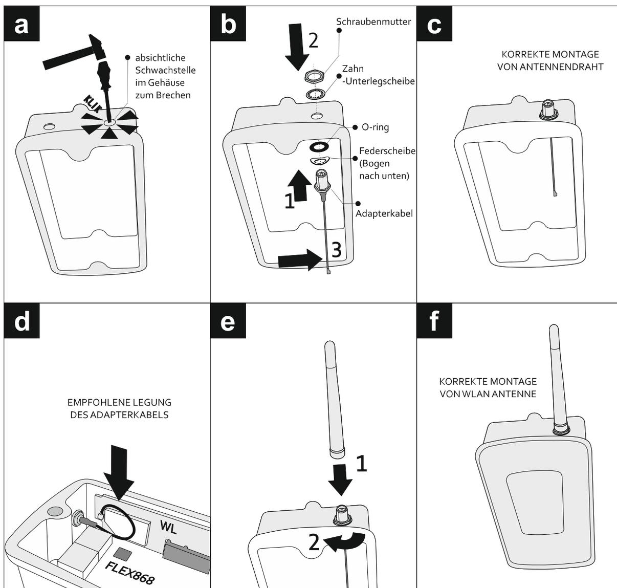
Abb. 2 Montage der Karte WL im Funkempfänger FLEX868.
