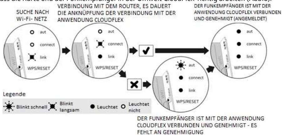
Abb. 8 Anknüpfung der Verbindung mit der Anwendung CloudFlex.
