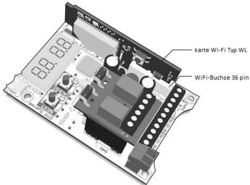
**Abb. 3** Richtige Montage der Karte WL im Funkempfänger FLEX868.
