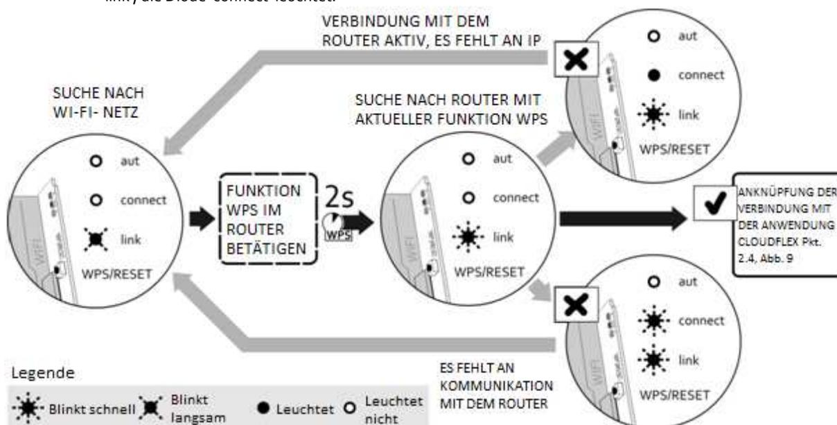
Abb. 4 Automatische Gewinnung der Einstellungen des Netzes Wi-Fi mit der Funktion WPS.
