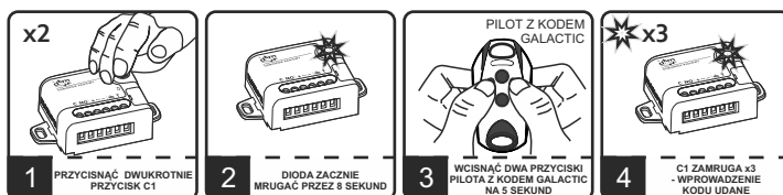
Rys. 4. Wprowadzenie kodu uwierzytelniającego funkcji Galactic do odbiornika.
