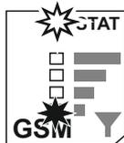
Die Diode STATUS blinkt pulsierend und die unterste Diode der Signalanzeige leuchtet auf
