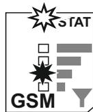
die Diode STATUS blinkt pulsierend und die zweite Diode der Signalanzeige von unten leuchtet auf
