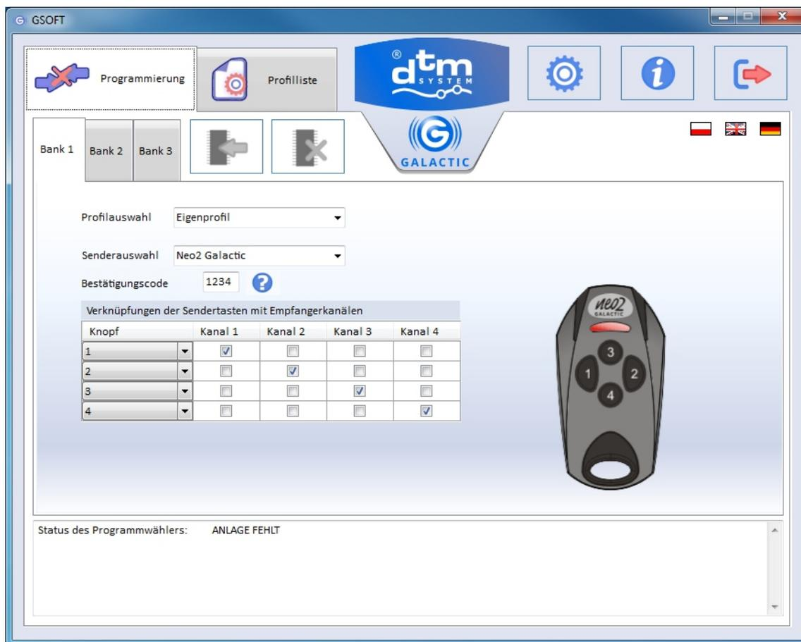
**Abb. 3** Sicht des Hauptfensters des Programms GSOFT mit der Information über keinen angeschlossenen Programmwähler GPROG.
