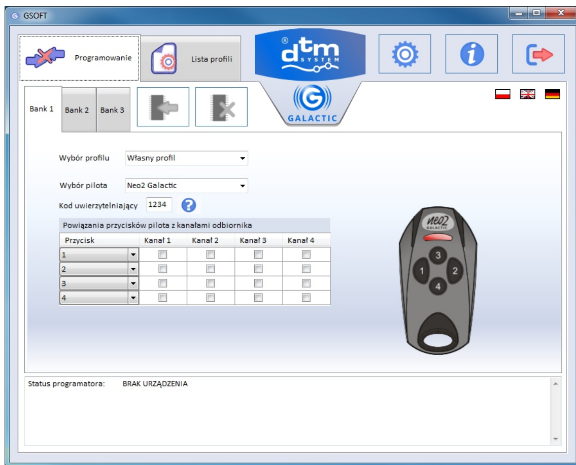
Rys. 3 Widok okna głównego programu GSOFT z informacją o braku podłączonego programatora GPROG.
