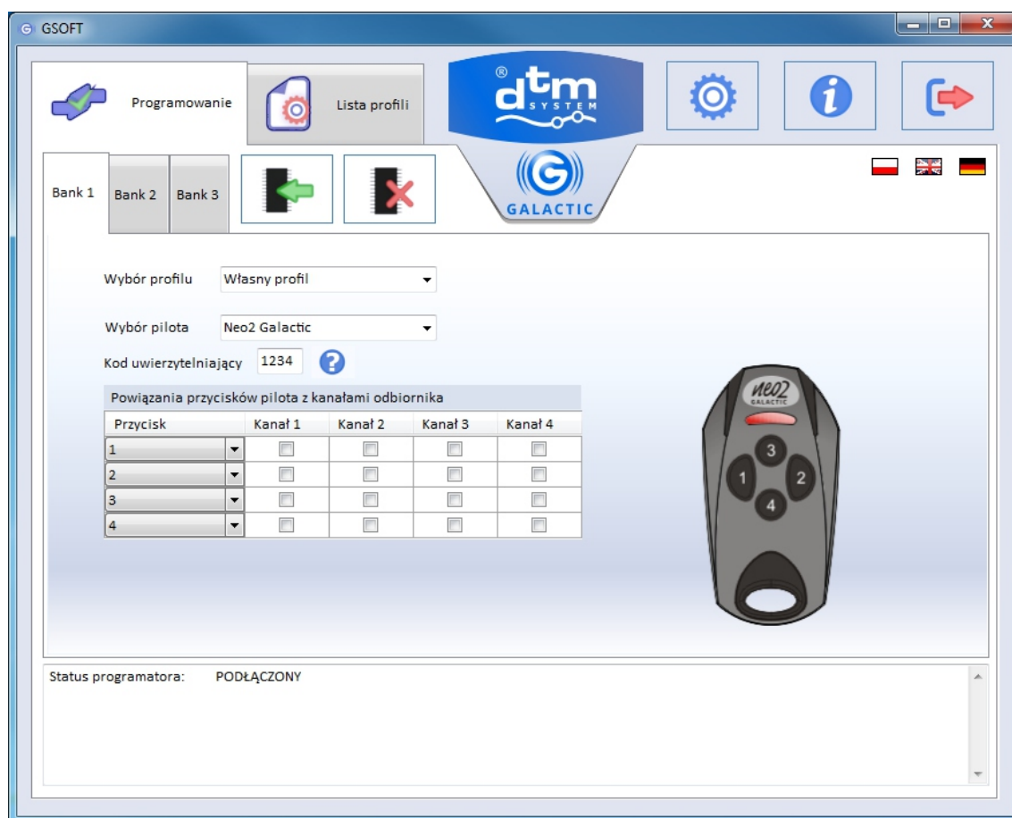
Rys. 2 Widok okna głównego programu GSOF z informacją o poprawnie podłączonym programatorze GPROG.
