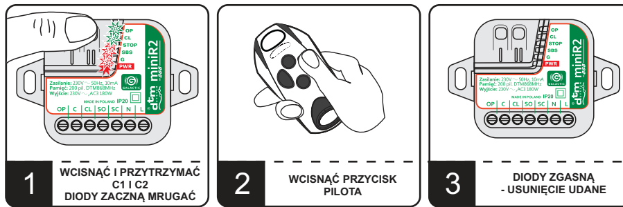
Rys.5 Usuwanie pojedynczego pilota.
