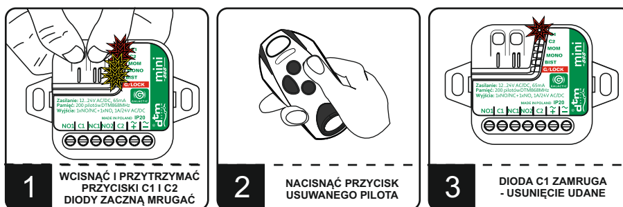
Rys. 3. Usuwanie pilota z pamięci odbiornika.
