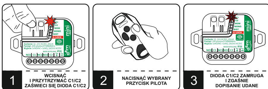
Rys. 2. Wpisywanie pilota do pamięci odbiornika.
