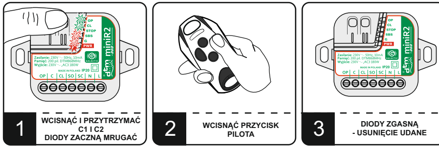
Rys.5 Usuwanie pojedynczego pilota.
