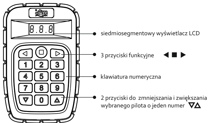
Rys. 1. Widok nadajnika z opisem przycisków.
